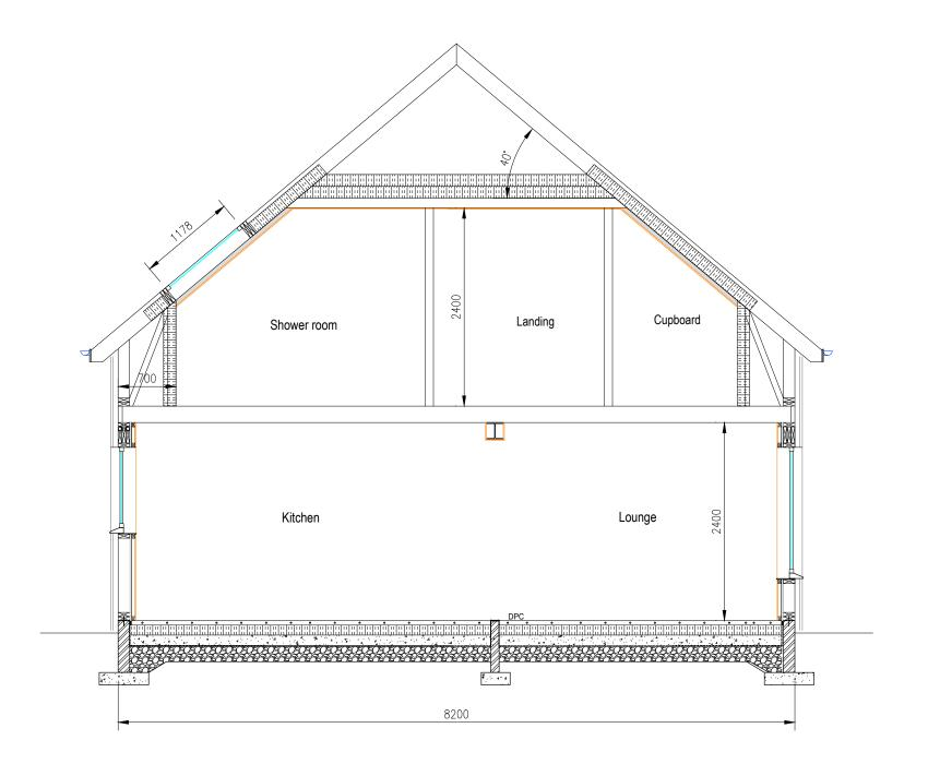
TYPICAL SECTION A-A SCALE 1:50
